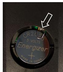
Colocar la pila (respectando la polaridad) en su alojamiento de tal manera que quede colocada debajo del clip metálico.
